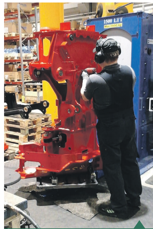
Metsäkoneen harvesteripään runko kokoonpanolinjalla.
